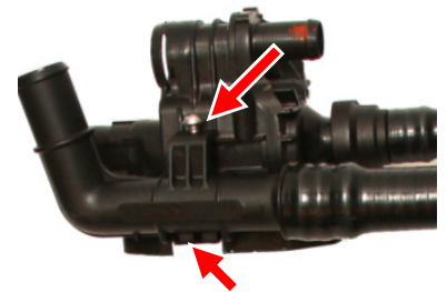
Montaje Termostato y Tubo
